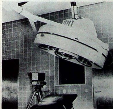
Bild 1. In die Operationsleuchte eingebauter Farbkamerakopf; im Hintergrund die Schwarz-Weiß-Umfeldkamera der Fernsehübertragungsanlage
